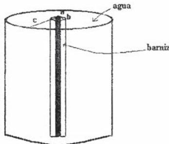
Este sistema de dos cilindros coaxiales que forman el resonador tiene una capacidad  $C$  y una resistencia  $R$  cuyo producto está dado por
