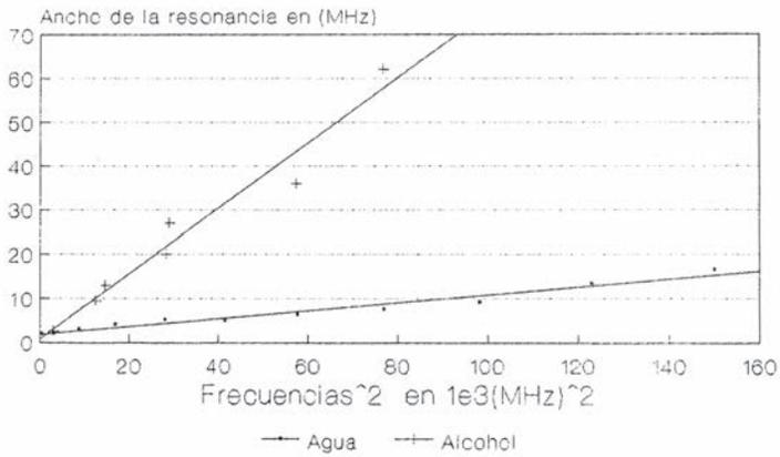
Los resultados obtenidos para las velocidades de propagación en aire, agua y alcohol se ajustan muy bien a los valores tabulados. Así mismo para los tiempos de relajación. Sin embargo se tiene cierto desajuste para la constante dieléctrica del agua. La razón de este desajuste estriba en la presencia del barniz de recubrimiento del hilo que, de hecho, constituye por sí mismo otro medio dieléctrico con su propia permitividad. La consideración de ésta permite entender los resultados.
